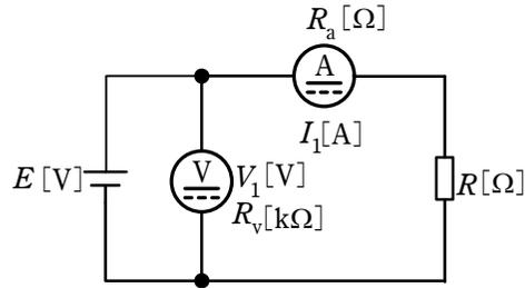
(a) 電流計の電力損失の値 [W] を表す式として、正しいものを次の (1) ~ (5) のうちから一つ選べ。
