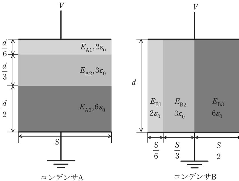
(a) コンデンサ A における各誘電体内部の電界の強さの大小関係とその中の最大値の組合せとして、正しいものを次の(1)～(5)のうちから一つ選べ。
